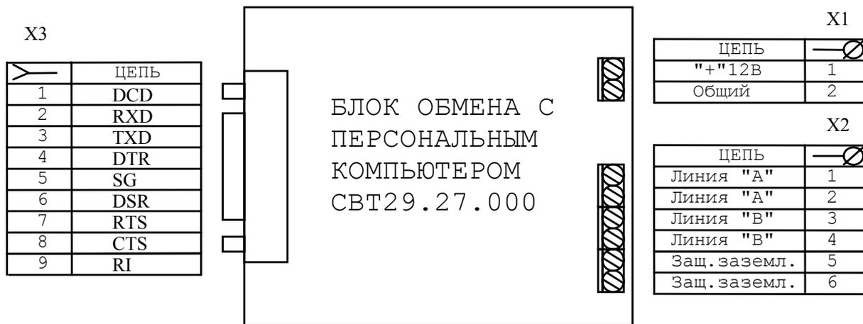
Рис. 3. Клеммные колодки блока обмена с ПК
